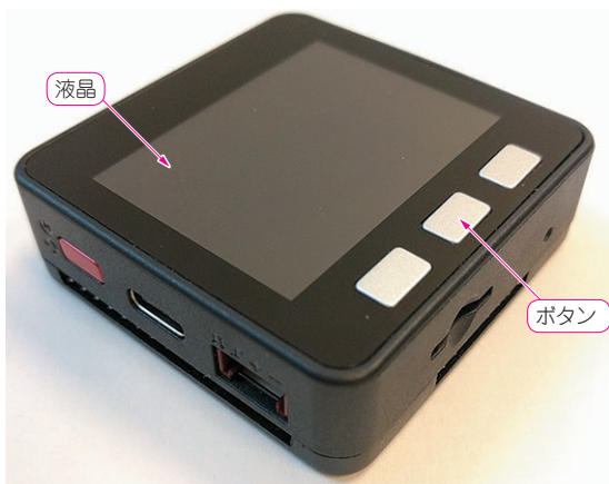
写真1 M5StackはIoTマイコンESP32モジュールと液晶/ボタン/バッテリーがワンパッケージになっていて実験にとっても便利
