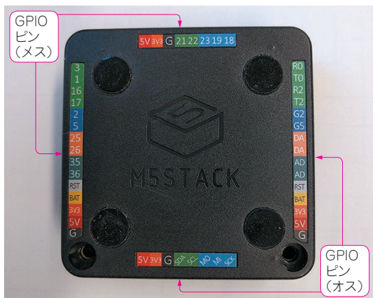
写真2 裏ふたにはGPIOピンが用意されている オス・メス両方が用意されているのも気が利いている
