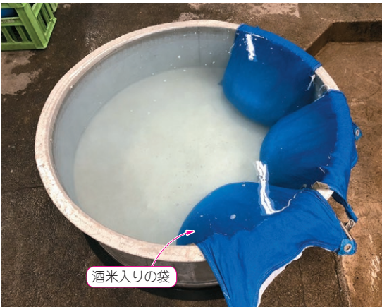
写真1 カリカリに削った酒米は水をとてもよく吸うので漬ける工程は秒単位の管理が重要
