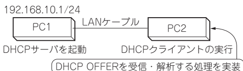
図1 今回行うこと…DHCP OFFERの受信解析処理をDHCPクライアントに実装する
