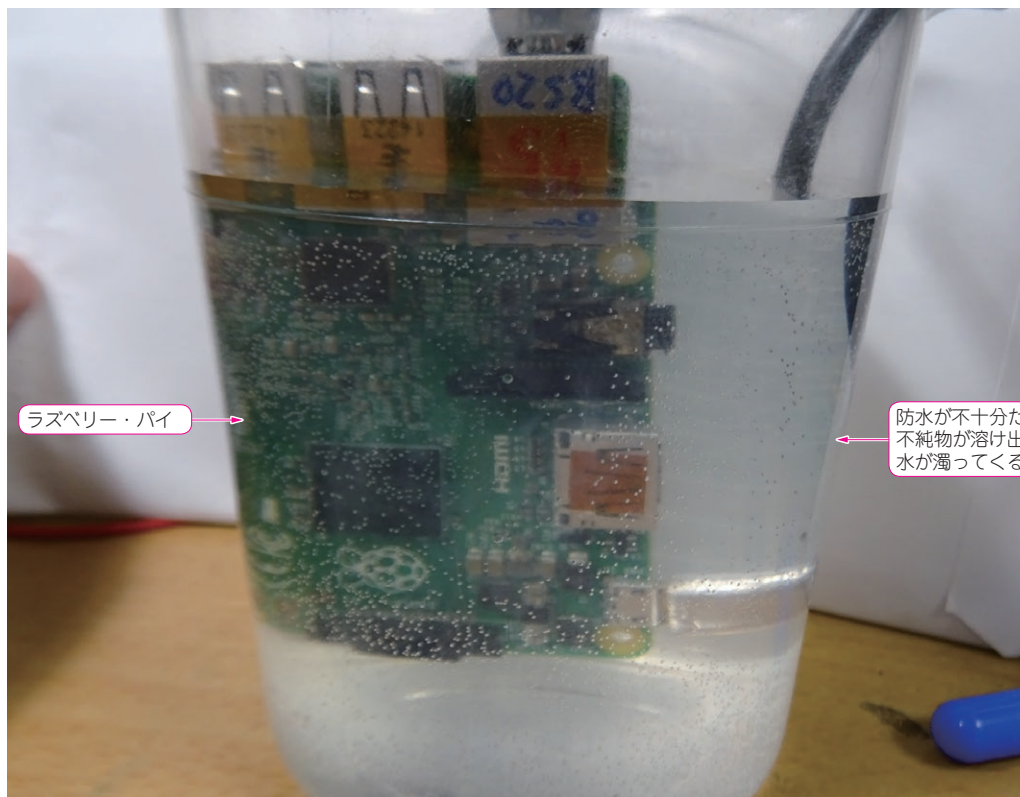
写真1 ラズベリー・パイをそのまま水道水に漬けて動かしてみる
