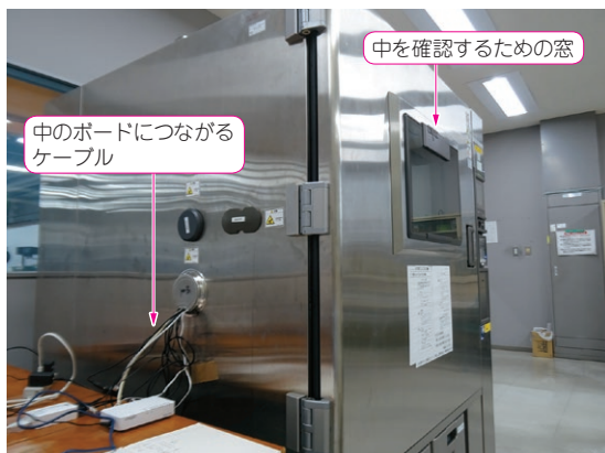
写真1 温度や湿度を一定に保てる恒温恒湿槽にラズパイを入れて実験を行う
