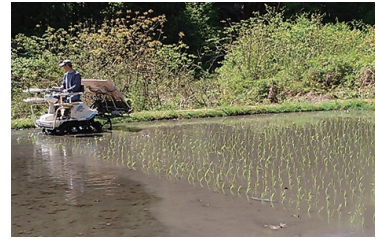
写真3 田植え機を使って苗を田んぼに植えている この機械は4帖植え…1回の走行で4列の苗を植えることができる
