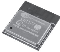
(b) Wi-Fi通信モジュール ESP-WROOM-02 (Espressif Systems, 約600円)
