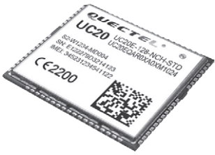
(a) 3Gセルラー通信モジュール UC20 (Quectel Wireless Solutions, 約5000円)
