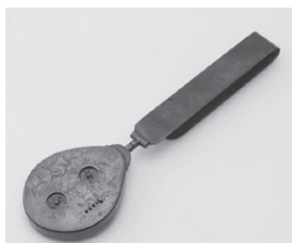
写真1 昔からあるウェアラブルな歩数計(セイコミュージアムより) 図1 10~20年前の歩数計が歩数をカウントする仕組み
