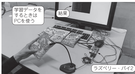
写真1 音のディープ・ラーニングによるお菓子の中身（種類）判定をラズベリー・パイで体験してみる
