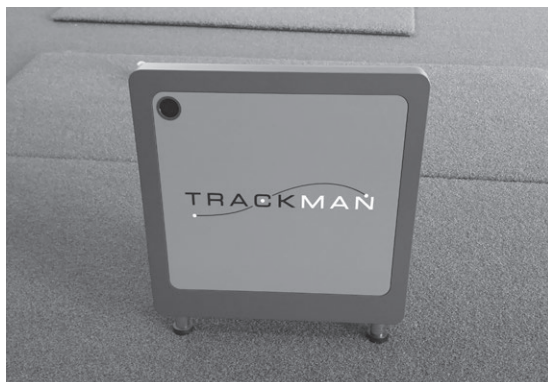
写真1 マイクロ波のドップラー効果を使って速度・回転数を合わせたボールの弾道を計測できるTrackMan A/S
