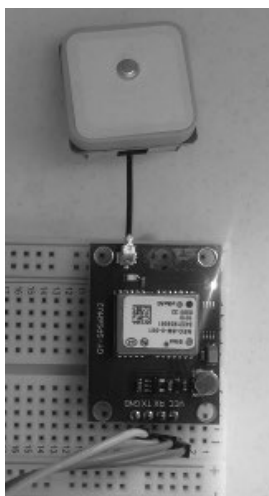
写真2 選んだUART接続のGPSモジュール 基板に実装済みのGPSモジュールとアンテナ・モジュールのセット NEO6M-ANT-4P. aitendo( http://www.aitendo.com/ )で2,780 円(税別)で購入できる
