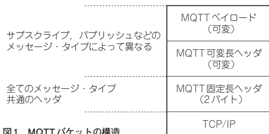
図1 MQTTパケットの構造
