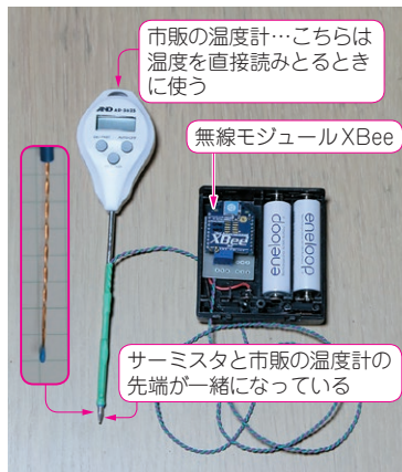
写真5 今回のIT化アイテム①…米麴の温度センサ 麴室を30℃に保つために温度を管理
