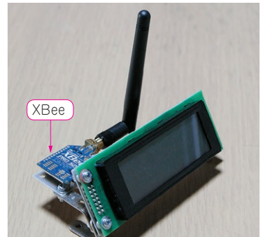
写真6 今回のIT化アイテム②…ワイヤレス温度モニタ 麴室のドアを開け閉めしたくないため遠隔で温度を見られる
