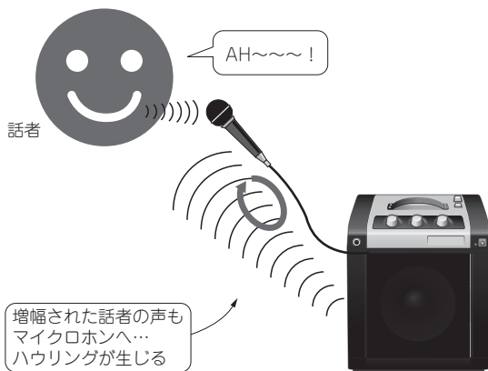
図1 音のフィードバック（ループ）があるとハウリングが生じる
