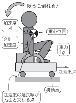
図2 車両加速度と重力加速度の延長線が地面と交わる点が後輪より後ろにあると転倒
