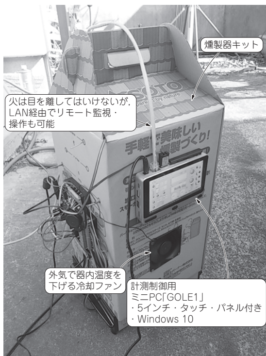
(a) 市販燻製器キットに計測制御用ミニPCを組み合わせ
