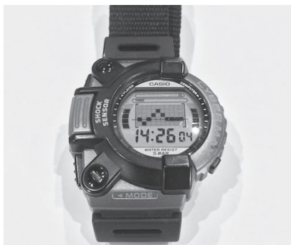
写真1 当時としては画期的…筆者も開発に携わった20年前の加速度センサ付きCASIO CYBERMAX JG-300
