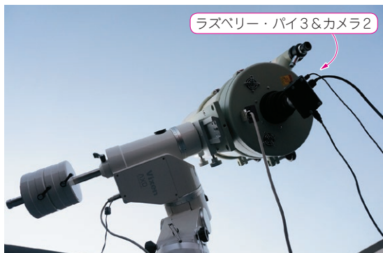
写真2 望遠鏡と800万画素ラズベリー・パイ・カメラ2と画像処理を組み合わせると木星の撮影に挑戦してみる
