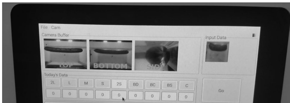
写真1 ラズベリー・パイ3をキュウリ自動選別コンピュータとして動かしてみる
