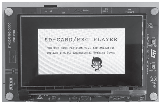
(b) SDカードやUSBメモリからリアルタイム音楽/ 画像再生が行える
