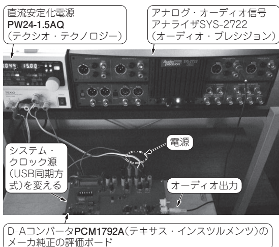
写真1 今回実験すること…システム・クロック源(USB同期方式)の違いによるアナログ信号波形への影響を実験で確かめる
