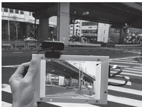
写真1 作るもの…カメラで外の世界を見て人工知能が理解したことを音声で伝えてくれる携帯型音声ガイドAIデバイス
