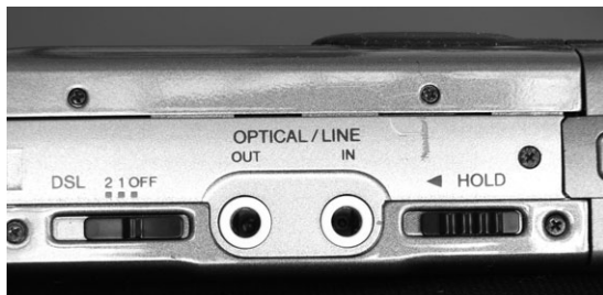
写真2 その2-1…3.5φステレオ・ミニジャックと共用の丸型光コネクタ
