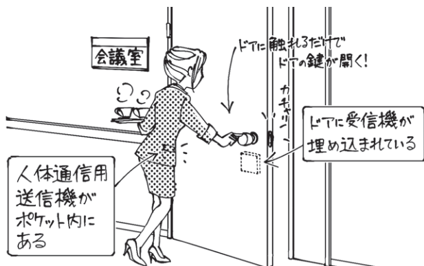
図1 電界式人体通信の例…送信機を身に着けておいて受信機内蔵のドアノブに触れると通信できる
