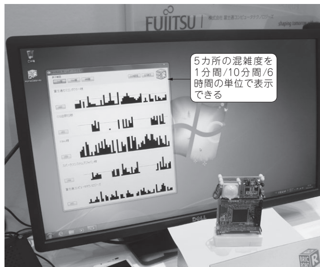
写真2 展示会の混雑度を測ってパソコンに集計中 昨年末に開催されたEmbedded Technology 2012の会場5カ所に設置して混雑度を観測した
