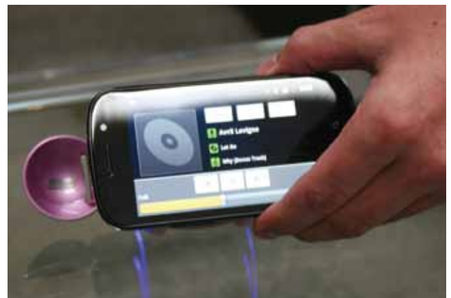
(b) 音楽を流している状態のAndroid携帯をスピーカ(NFCタグ)にかざすと、音楽がスピーカから流れはじめる
