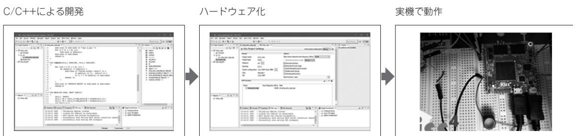
図1 SDSoCを使った開発の流れの概要 C/C++で記述したアプリケーション・プログラムの一部を自動的にハードウェア化できる。ARMプロセッサ搭載FPGAのZynqで動作させることができる
