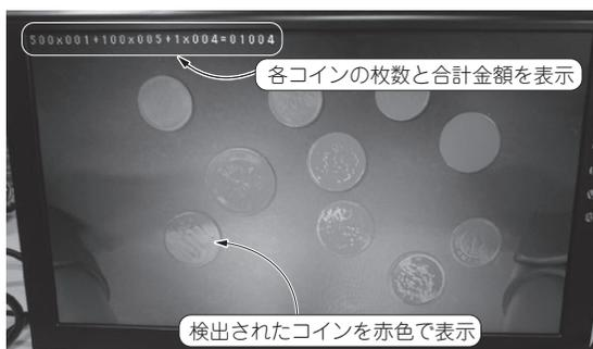
写真1 コインの合計金額を計算して表示している
