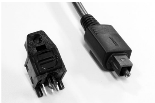
写真1 光(オプティカル)コネクタとケーブル
