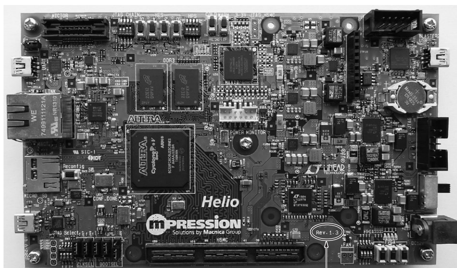
ボードのバージョン (Rev.) はここに明記されている。写真のボードは Rev.1.3。
